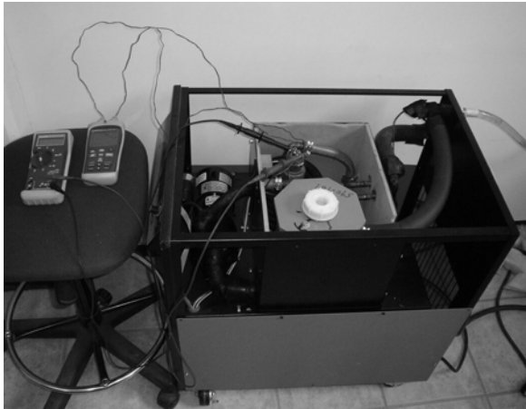
Figura 2. Baño recirculador de agua a temperatura constante.
