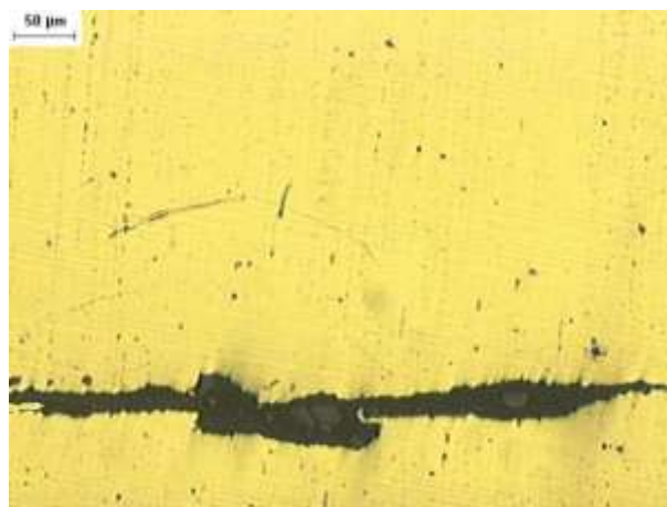
Fotografía N° 6.- Laminación con inclusiones.
