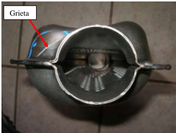
Fotografía N° 1.- Ubicación de la grieta, vista de frente.
