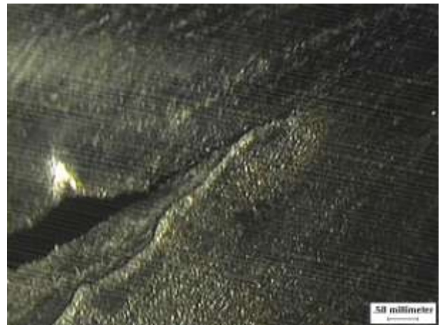
Fotografía N° 4.- Punta de la grieta con laminación.
