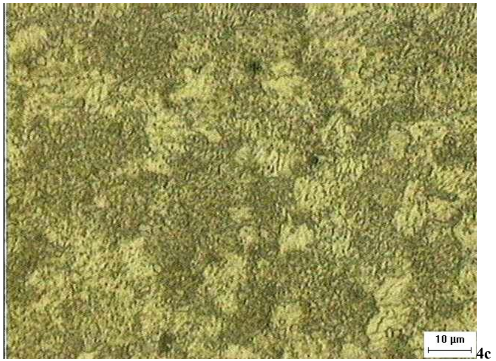
Fotografías 4.- Microestructuras de las aleaciones: 4a) Sn-Ag-Bi sin tierras raras, 4b). Sn-Ag-Bi + Nd, y 4c). Sn-Ag-Bi + Pr
