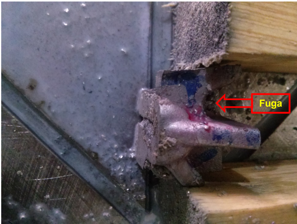
Figura # 2.- Pieza automotriz seccionada mostrando la zona de la fuga de aceite, detectada por medio de la técnica de líquidos penetrantes.
