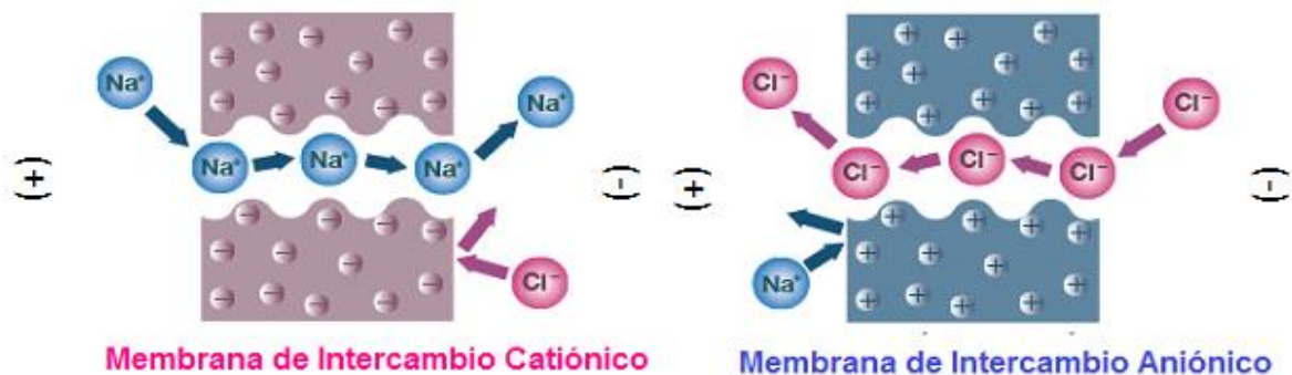
Figura 6.- Mecanismo de transporte iónico: izq) catiónico, der) aniónico.
