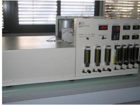
**FIGURA 13.** Equipo Desert Research Instrument (DRI) Carbon Analyzer, para la metodología IMPROVE.
