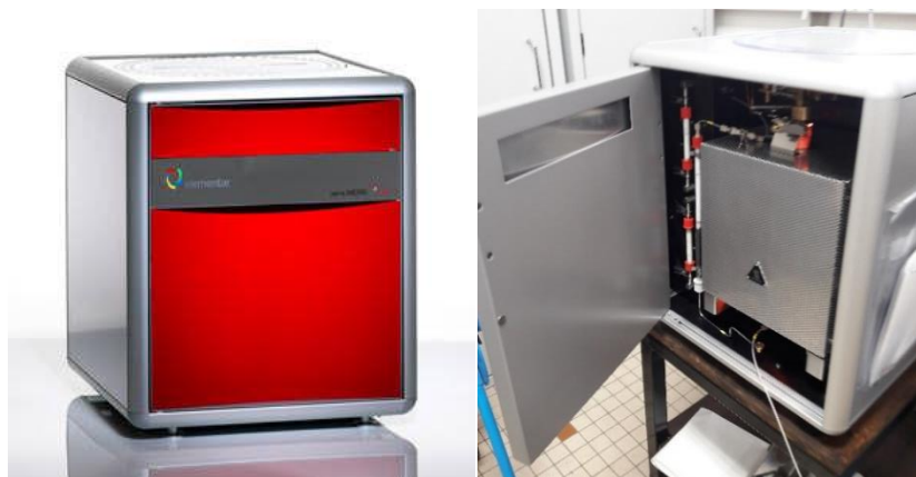
Figura 3.1 Equipo Elementar EL Cube, utilizado para análisis elemental.
