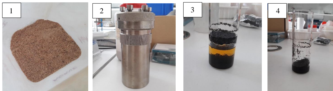
Figura 3.2. 1) Bagazo de agave, 2) Autoclave, 3) Hidrochar de bagazo de agave al término del proceso hidrotérmico, 4) Hidrochar sin fracción líquida.
