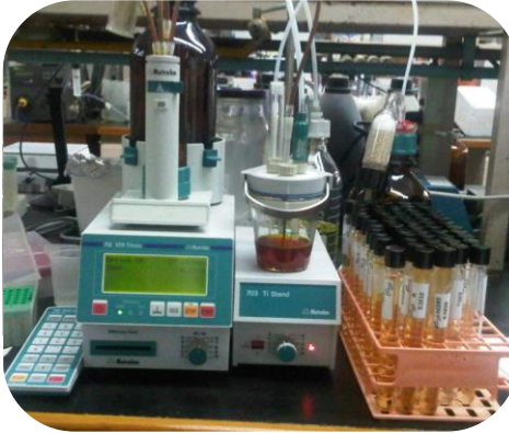
Figura 6. Esquema del equipo Karl Fisher para determinar el %de Agua en el electrolito
