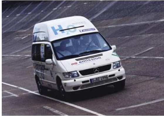
Figura 1.4. NECAR 2 alcanza hasta 110 km/h, capacidad para 6 pasajeros. Los tanques de hidrógeno están ubicados en el techo del vehículo.
