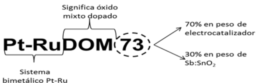
Figura 2.2. Significado de la nomenclatura empleada para los electrocatalizadores obtenidos por el método de molienda mecánica.
