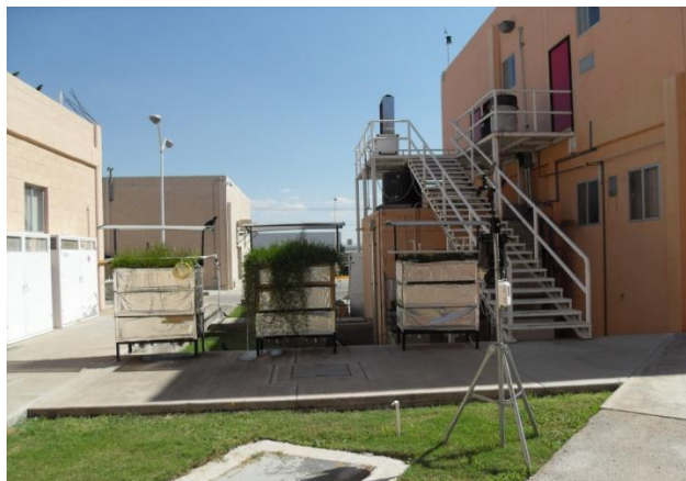
Ilustración 17. Estación meteorológica automática e inalámbrica marca DAVIS.
