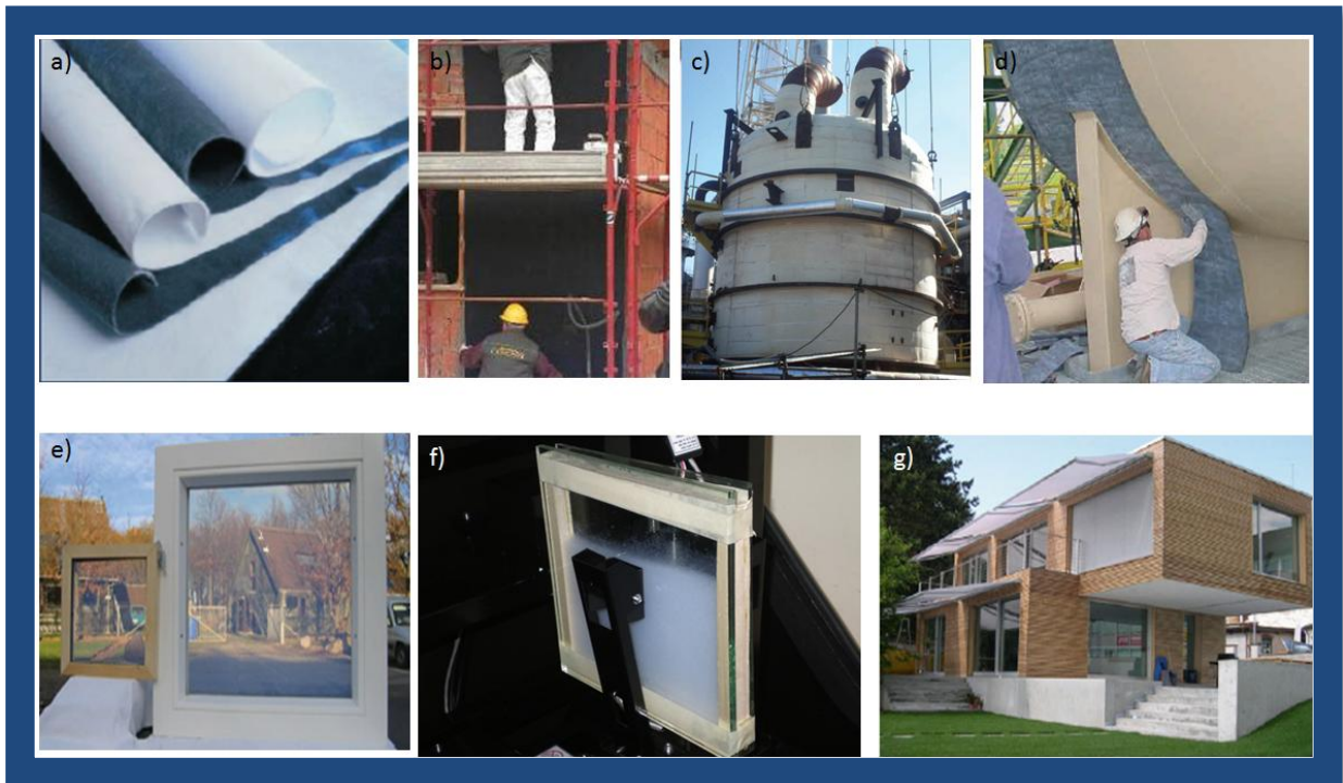
Figura 19: imágenes de diferentes tipos de aislamiento utilizando aerogel de silicio en diversas formas. a) Aerogel en forma de manta, elaborados por las compañías Aspen y Cabot. b) Aislante al exterior de un edificio. c) Torre de destilación aislada con aerogel. d) Reactor aislado con aerogel. e y g) Ventanas de aerogel solido (monolito). f) Ventana con aerogel en polvo. [Michel A. Aegerter et al., (2011)]
