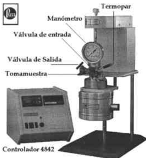
Fig. 20 Reactor por lotes para la HDS del DBT
