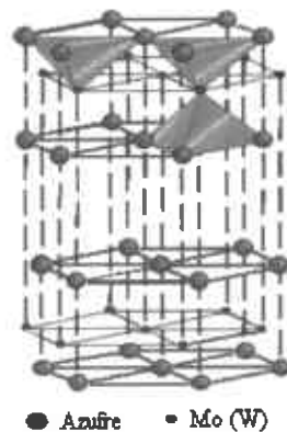
Fig 7. Esquema de la celda unitaria para la estructura de los sulfuros de Mo y W [19].
