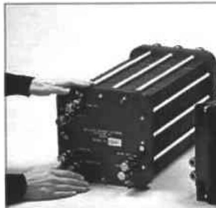
Figura 2b. Apilamiento de celdas
