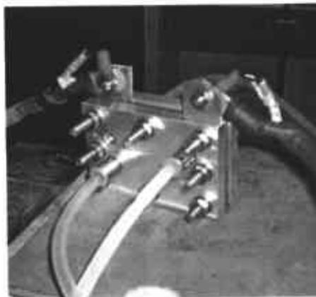
Figura 21. Celda de combustible PEM elaborada
