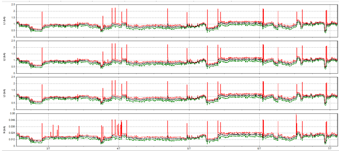
Figura 32. Perfil de la corriente en el Transformador 2 1000 KVA de la subestación 2.
