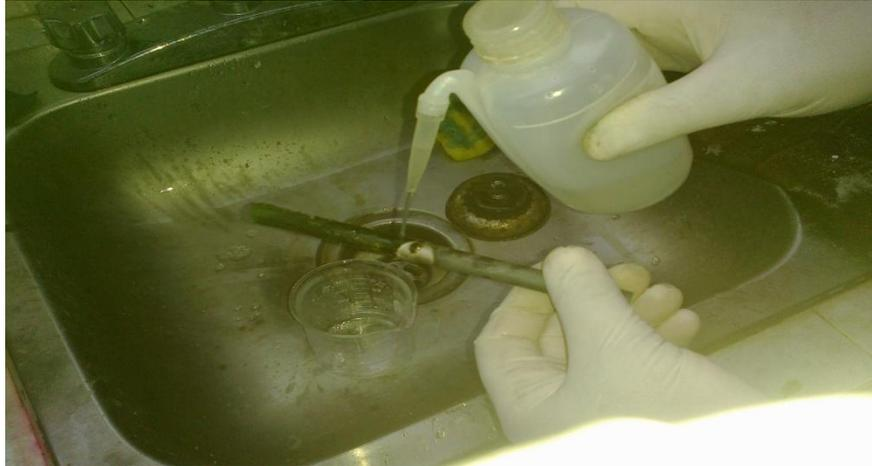
Figura 34.- Limpieza del grafito y barra de carbón con agua destilada.
