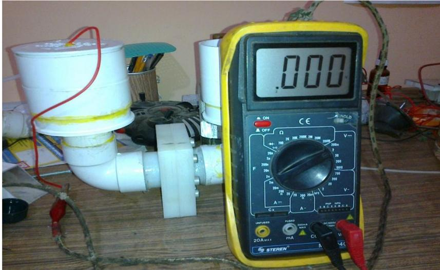
Figura 14.- Celda tipo H armada donde se mide el voltaje utilizando un multímetro de alta impedancia.
