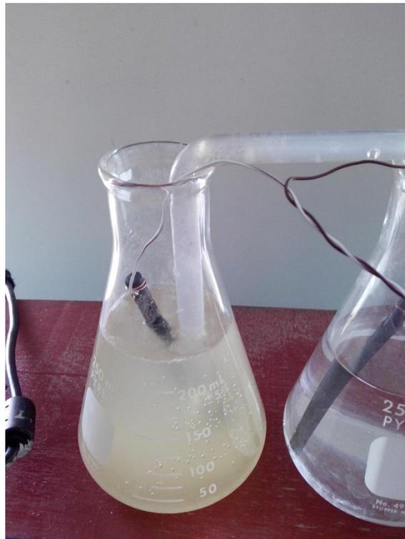
Figura 44.- En esta figura se muestra la generación de burbujas que presento la cámara anódica al paso de 1 a 2 días, del corrimiento.
