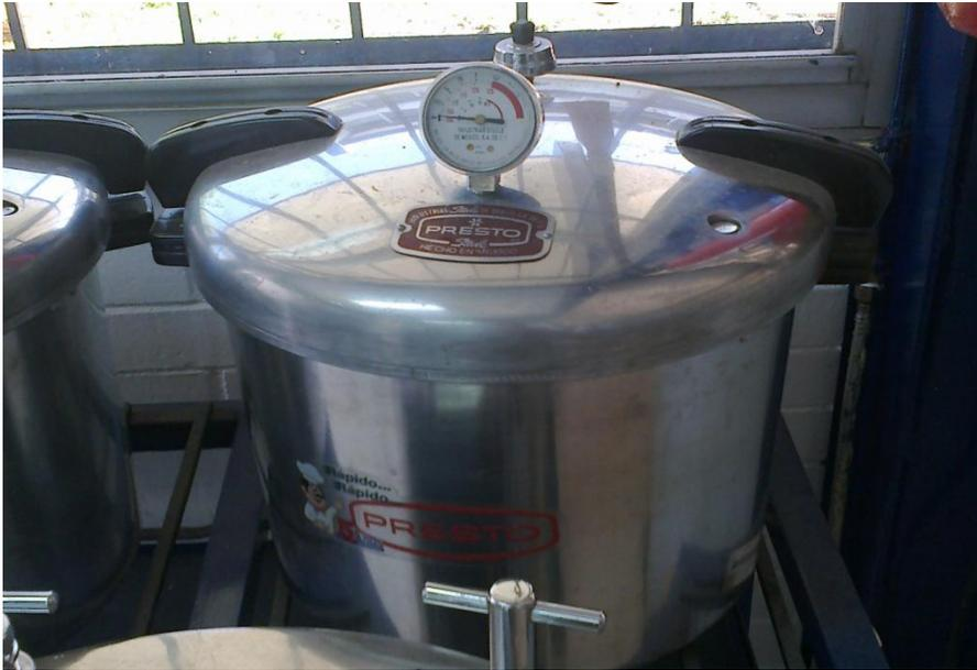
Figura 7.- Autoclave para la esterilización de la cámara.
