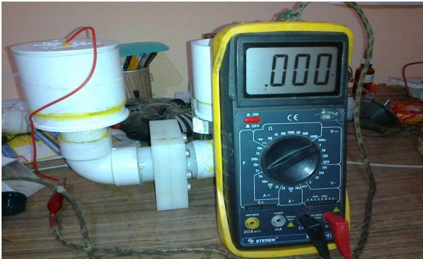
Figura 18.- Celda tipo H armada utilizando el guante de hule como membrana y monitoreando el voltaje con un multímetro marca Steren.
