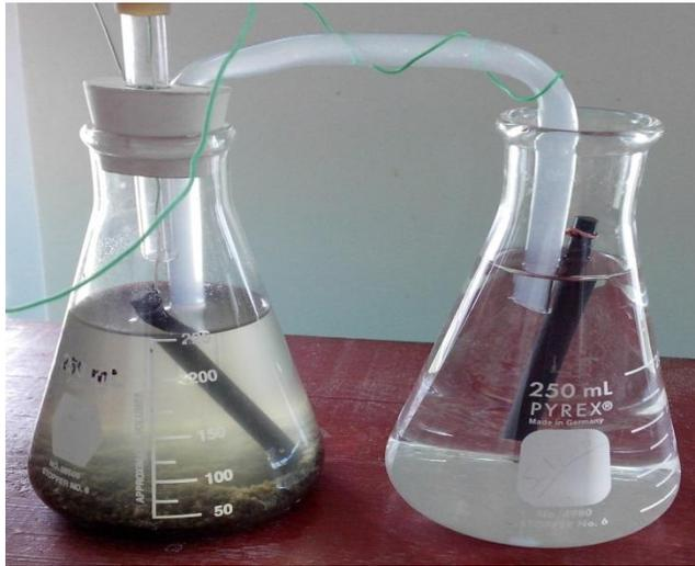
Figura 42.-Celda 2 dos cámaras utilizando lodos como consorcio bacteriano y caldo glucosado con aguas residuales como sustrato, en ambas celdas se utilizaron barras de grafito como electrodo, ambas unidas con un puente salino.
