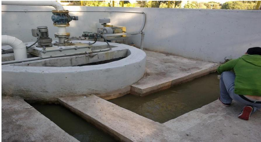
Figura 9.- Toma de la muestra del afluente, todas las muestras se depositaron en contenedores de vidrio previamente lavado, para posteriormente trasladarlas en una hielera con hielos.
