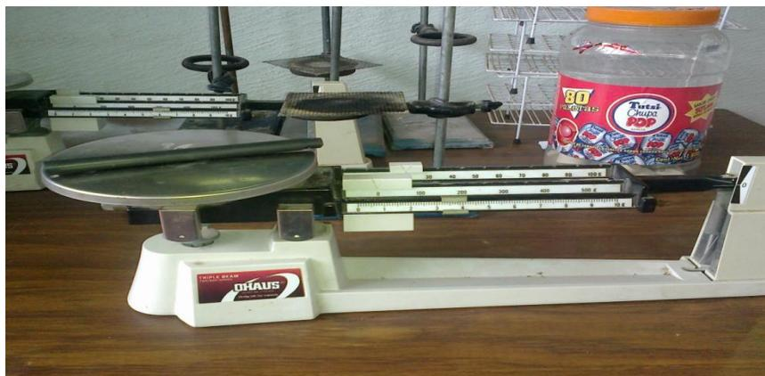
Figura 35.- Medición de la masa del grafito utilizando una báscula granataria.
