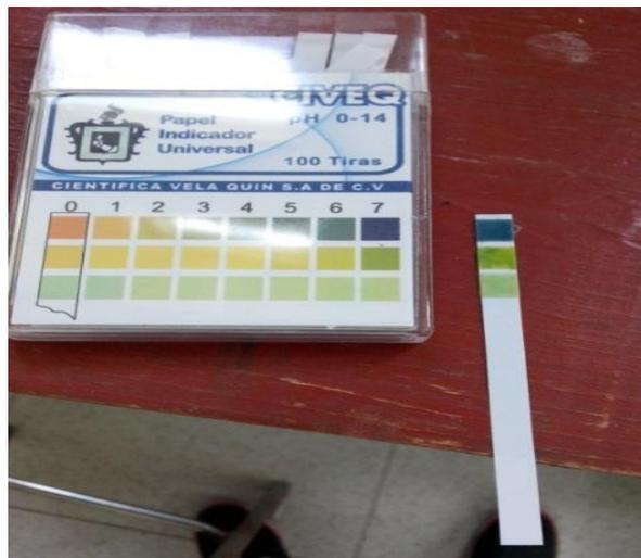
Figura 26.- Tiras utilizada para medir el pH en las celdas anódicas.
