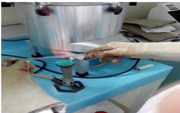
Figura 19.- En esta imagen se aprecia cómo se doblaron los tubos de vidrio para posteriormente utilizarlos como puentes salino.
