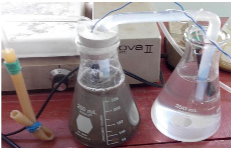
Figura 52.- En esta imagen se puede apreciar la forma que adquirió la cámara anódica después del onceavo día, en la cual previamente se le agregaron 25 ml de caldo glucosado.
