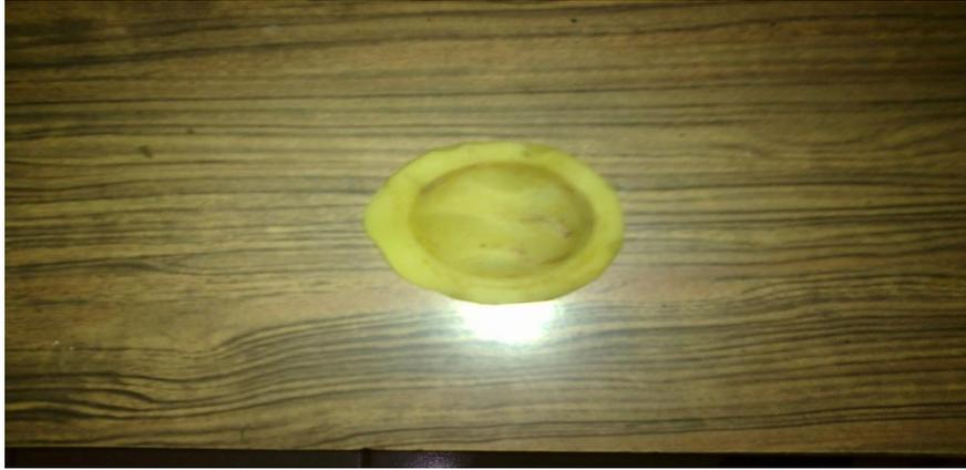
Figura 17.- Membrana de guante de hule utilizada para unir ambas cámaras.
