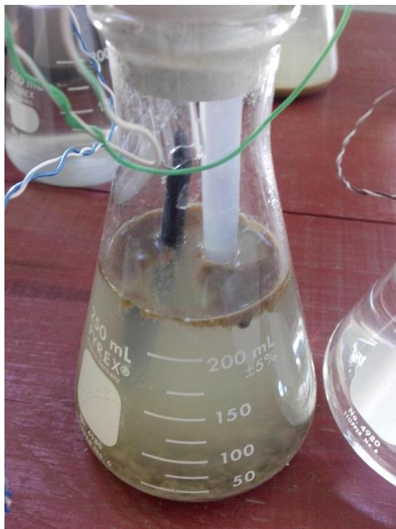
Figura 54.-Celda anódica en condiciones anaeróbicas al finalizar el corrimiento, con una floculación de lodos, y una pequeña capa de lodos en la parte superior del matraz.
