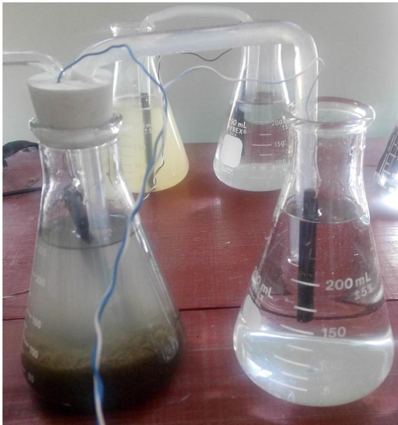
Figura 40.-Implementación de la celda microbiana de 2 cámaras unidas por un puente salino, operando en condiciones anaerobias, del lado derecho cátodo del izquierdo ánodo.
