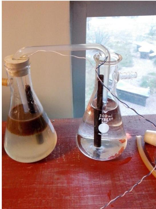
Figura 28.- Celda de 2 cámaras unidas con un puente salino, utilizando como consorcio microbiano lodos activados y como sustrato caldo glucosado, trabajando en condiciones anaerobia la cámara anódica.
