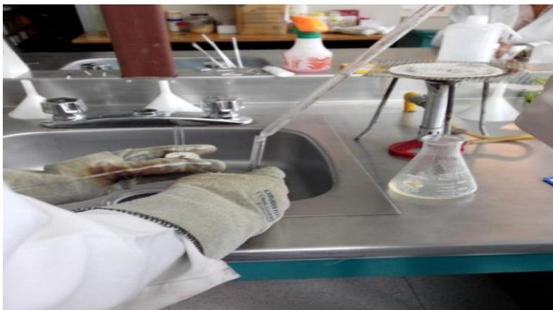
Figura 23.- Llenado de electrólito en tubos de vidrio
