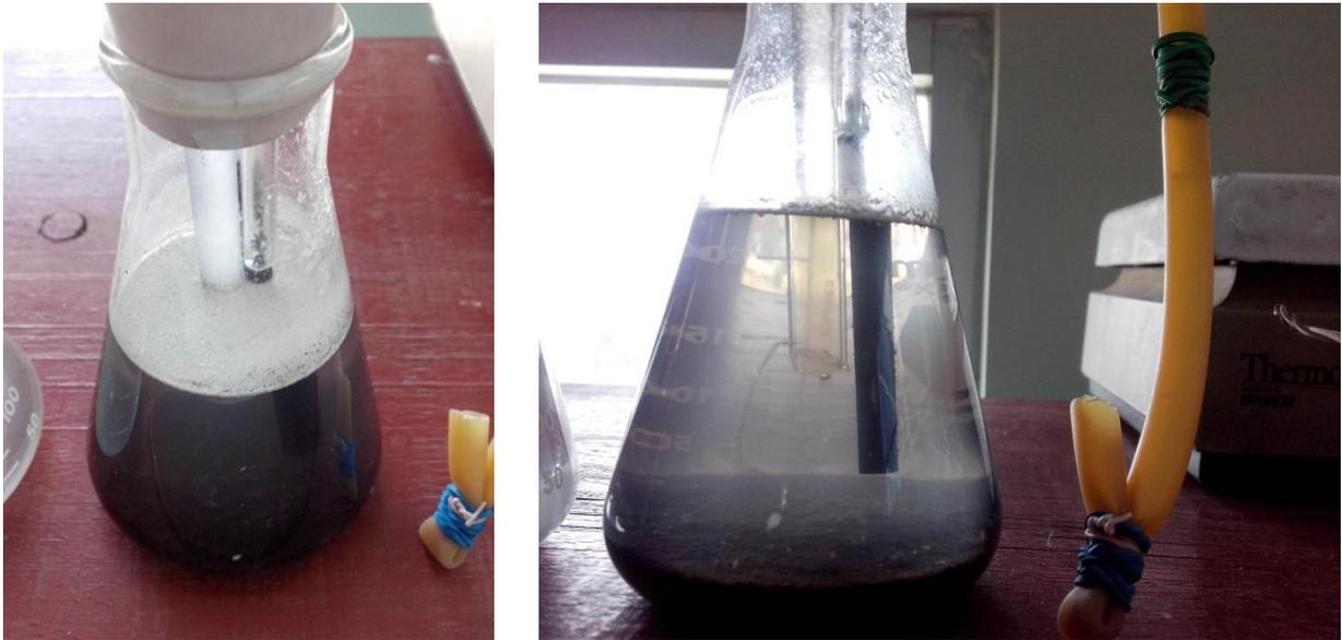
Figura 51.-En esta figura se aprecia la decoloración que tuvo la cámara anódica después del décimo día, donde se presentó una floculación de lodos, esto debido probablemente al consumo de caldo glucosado.
