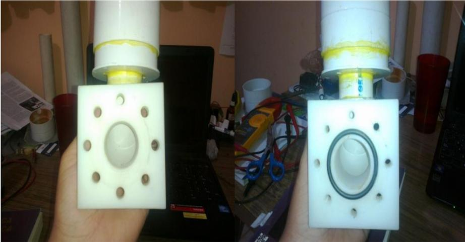
Figura 15.- Celda tipo H
