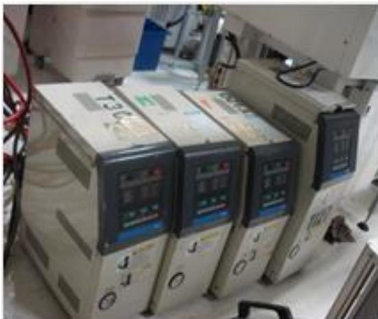
Figura 41.- Equipo Auxiliar, Thermolators
