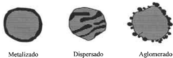
Figura 7. Diferentes tipos de ensamblaje de partículas para la fabricación de compósitos
