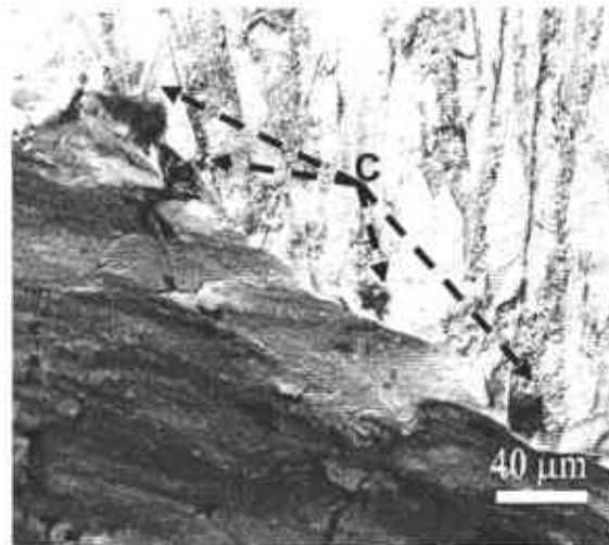
Figura 68. Fractura del compuesto Al 3.0/2.0 sinterizado a 350°C.
