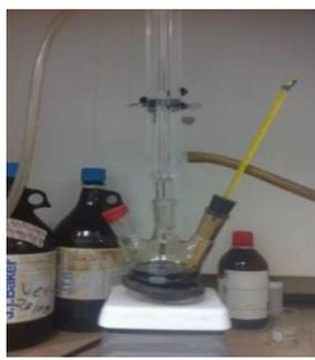
**Figura 12** Purificación de NTC por tratamiento ácido y calentamiento.
