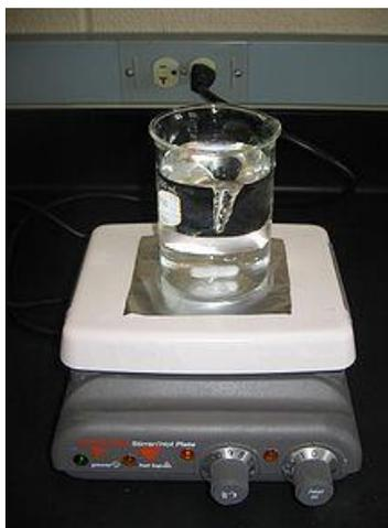
**Figura 14** Movimiento magnético para las reacciones de amidación.
