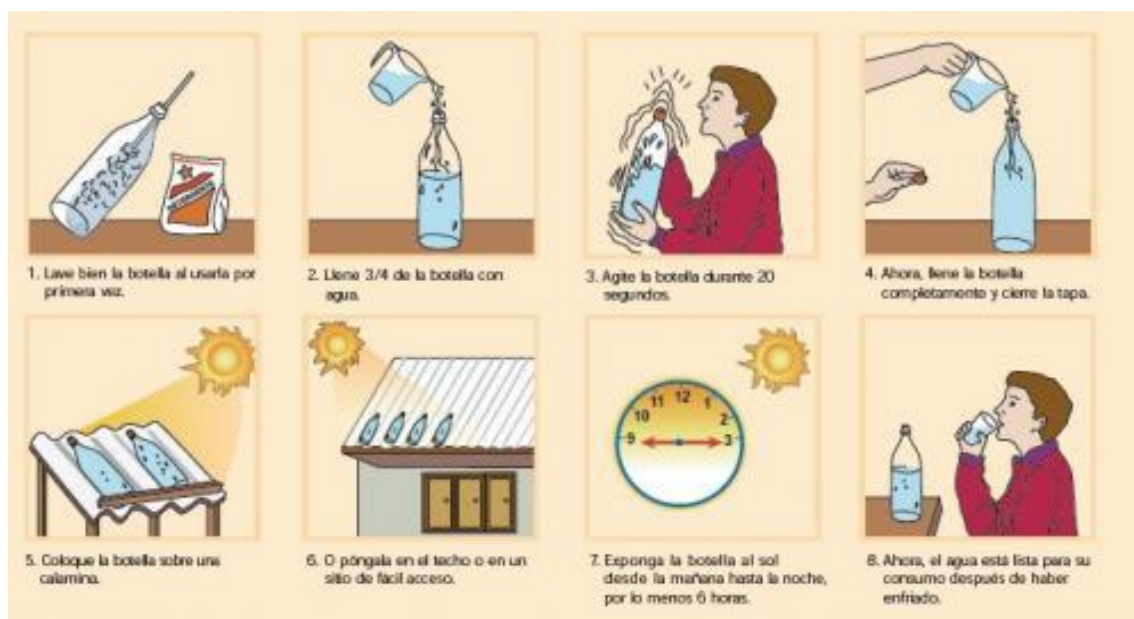
Figura 2. Método de desinfección de agua SODIS
