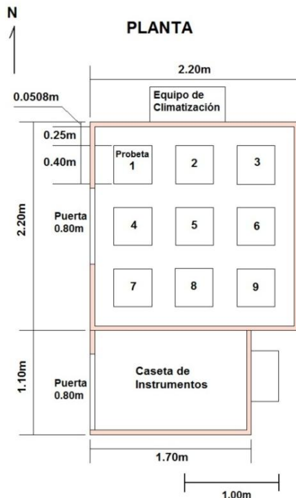
Figura 6. Vista en planta de la caseta experimental.
