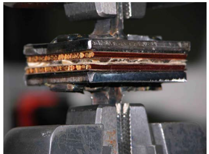
Figura 6. Falla del papel y de la interfase papel/conductor
