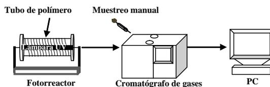
**Figura 1. Esquema del sistema de degradación fotocatalítica utilizado para la evaluación de los recubrimientos.**
