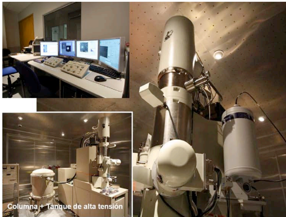
Figura 1.- Imagen del equipo instalado, consola de manejo, columna y alta tensión.
