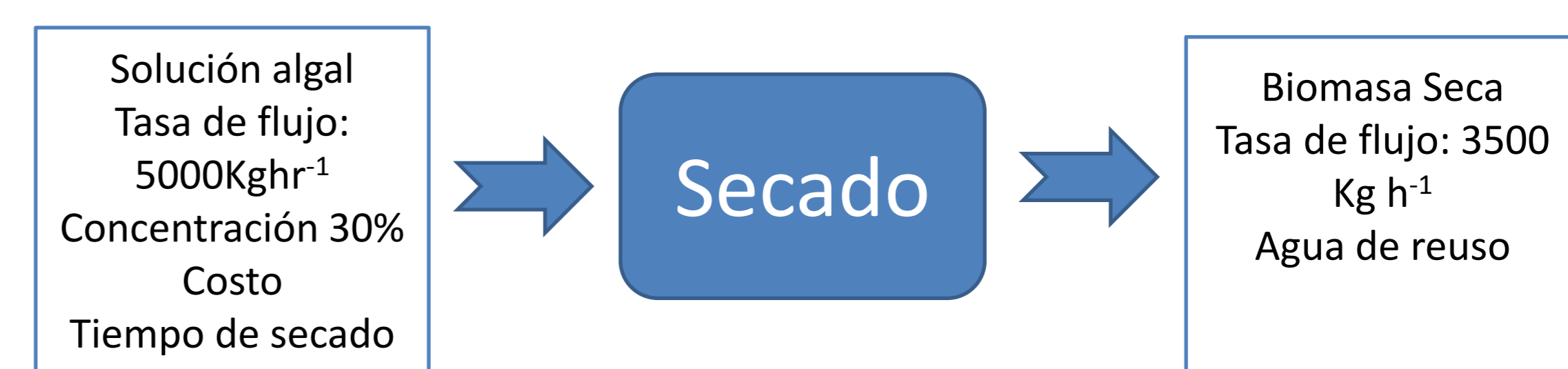
Figura 3. Entradas y salidas del proceso de secado.
