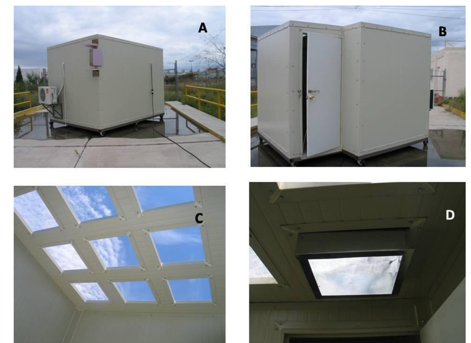
Figura 8. Caseta experimental. A) Equipo de acondicionamiento de aire, B) Vista exterior y acceso a la caseta, C) Vista al techo desde el interior mostrando los espacios para colocar las probetas, D) Estructura para el soporte de las probetas.
