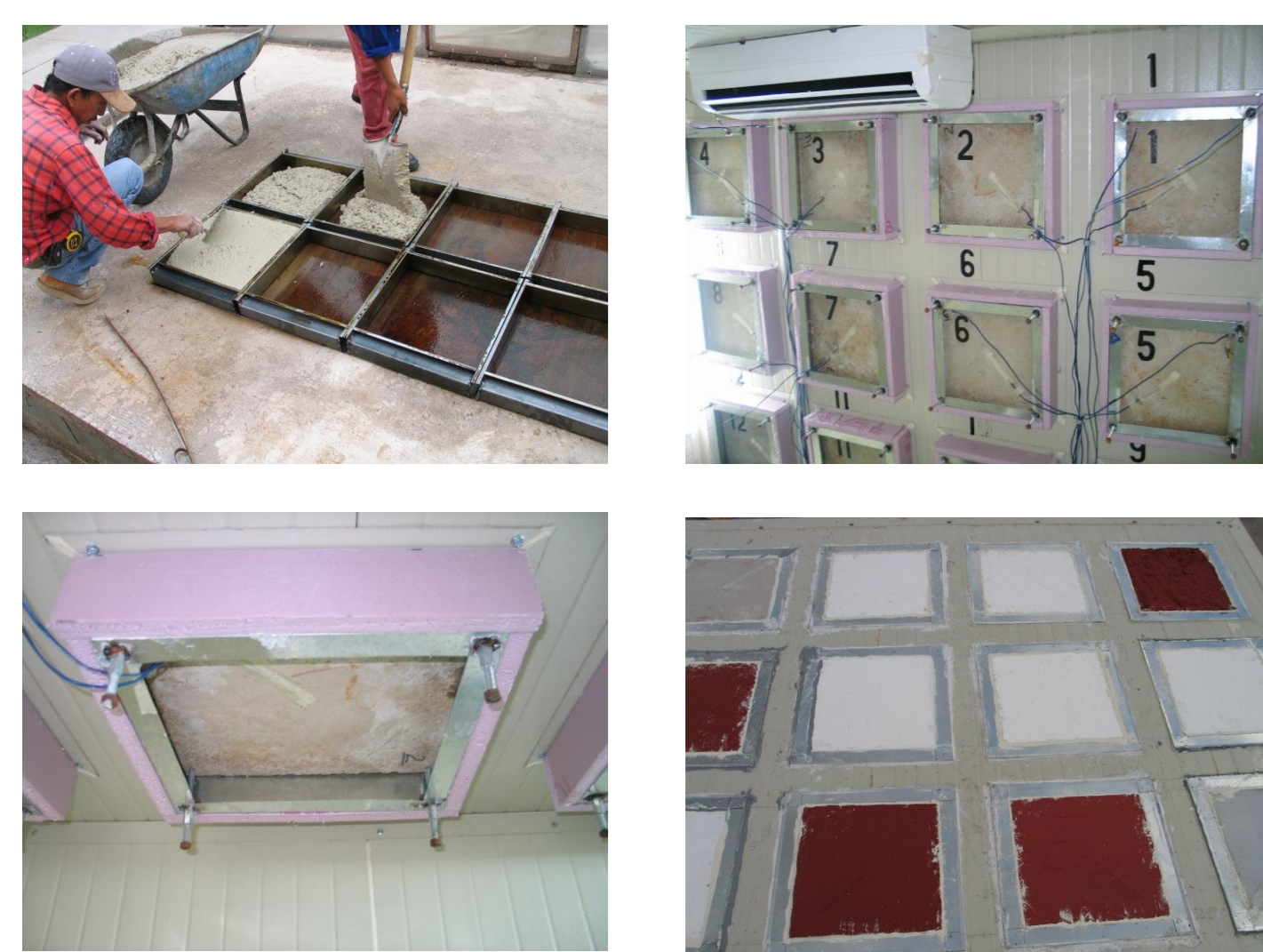
Figura 9. Caseta experimental, A) fabricación de probetas, B) vista interior del techo y probetas, C) soporte de las probetas y D) vista exterior del techo y probetas con recubrimientos.
