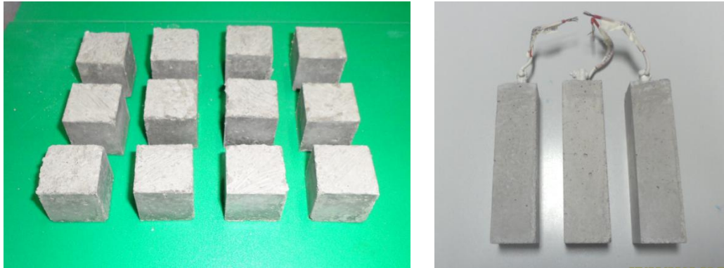
Figura 3. Probetas endurecidas antes de proceso de curado
