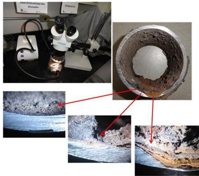
Figura 2. Análisis por Microscopio Estereoscopio de las picaduras
