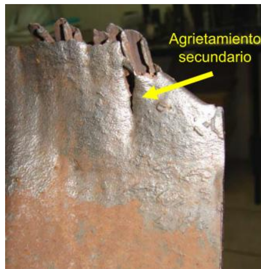
FIGURA 5. Sección transversal con agrietamiento secundario. Puede observarse el adelgazamiento del material, se notan las líneas donde va sentado el aleteado por la parte externa.
