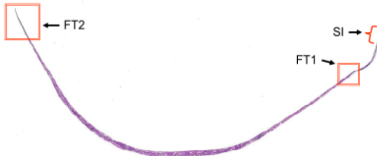
FIGURA 16. Huella de la sección transversal 2 indicando los sitios de toma de muestras para metalografía.
