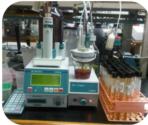
Figura 4. Esquema del equipo Karl Fisher para determinar el %de Agua en el electrolito
