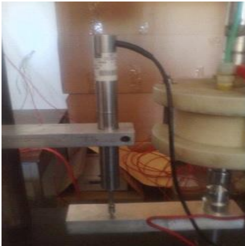
Figura 2. Maquina CERT con pieza de prueba y recipiente para medio de pruebas electroquímicas.
