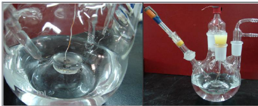
Figura 2. Arreglo de la celda electroquímica de tres electrodos
