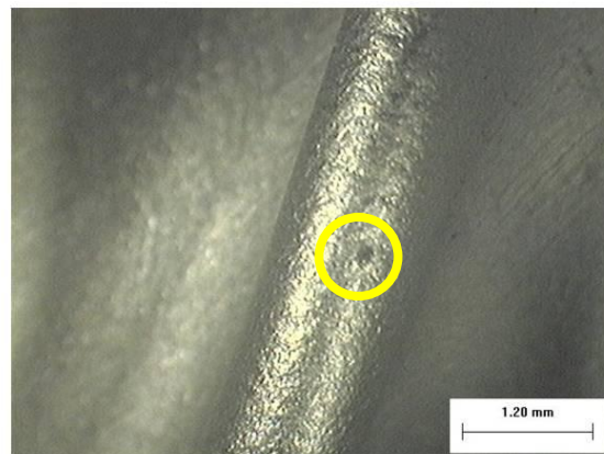
Detalle de morfología de ataque a 10X.
