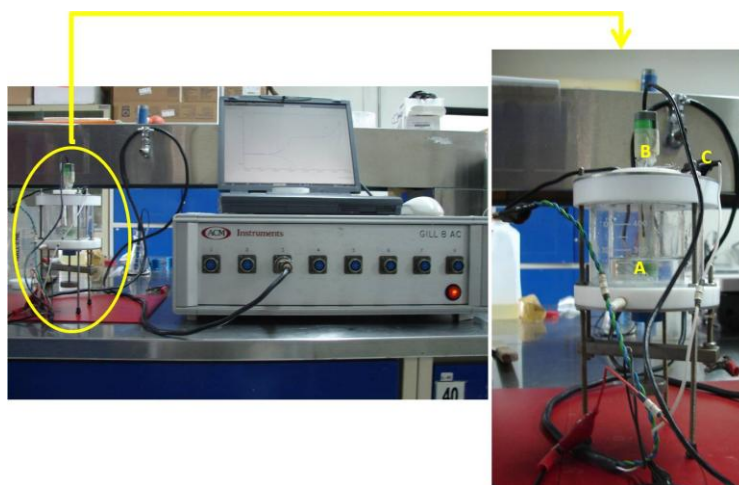
Figura 2. Celda de picado con un arreglo experimental de tres electrodos.
