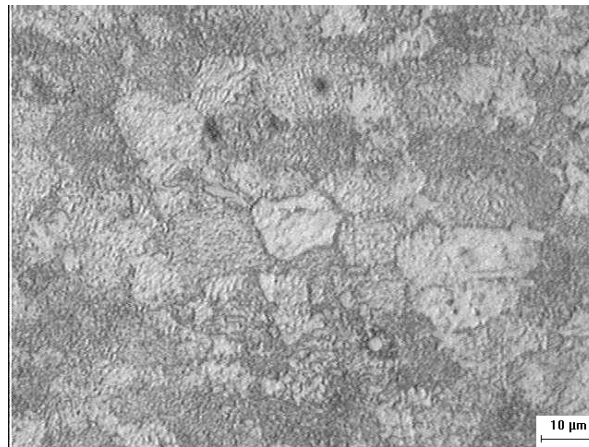
Figura 5. Microestructura de la aleación Sn-Ag-Bi, 500X.
