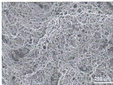
Figura 20. Morfología de la superficie de fractura del acero API 5L- X52 expuesto en el medio E10.
