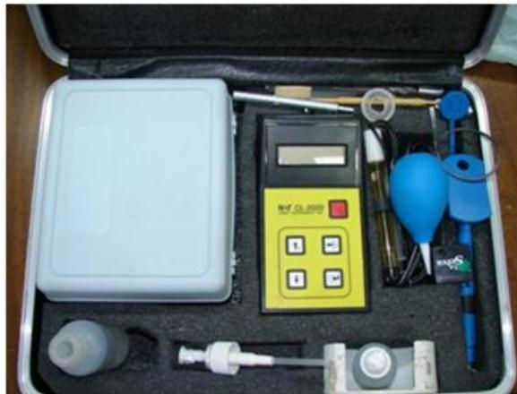
*Figura 15. Equipo para determinar cloruros*
