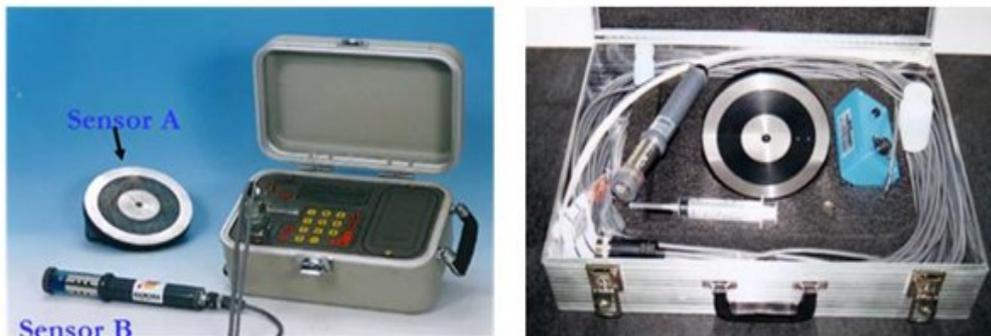
Figura 2. Equipo de Corrosión GECOR 6 de NDT Instruments
