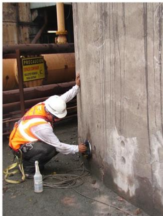
Figura 8. Medición de Velocidad de Corrosión
