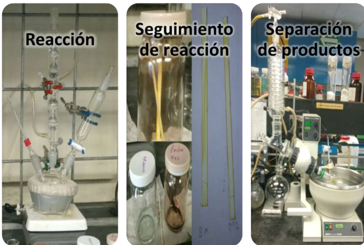
Figura 11. Procedimiento de la Síntesis propuestas para las moléculas inhibidoras de corrosión.
