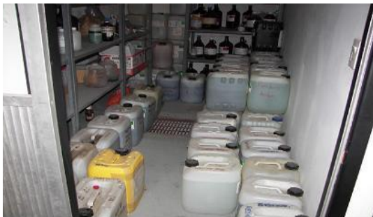
Figura 20. Almacén temporal de residuos peligrosos saturado.
