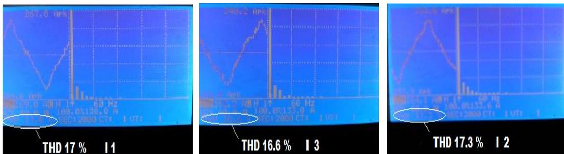
Imagen 5.5 Ondas Senoidales de Corriente
