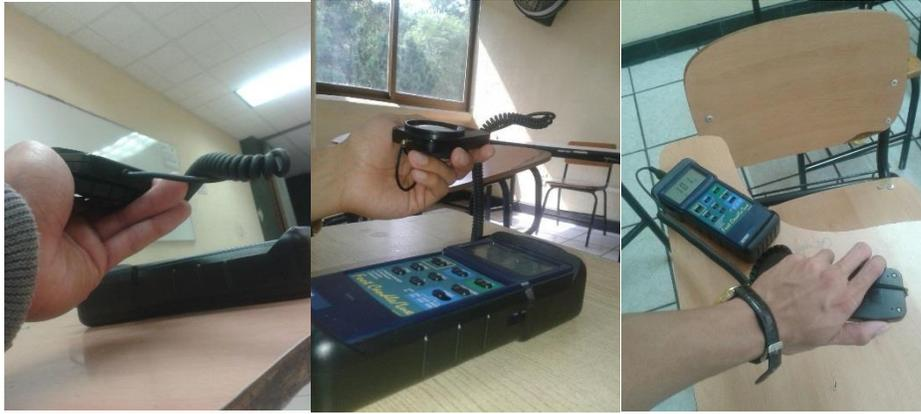
**Fig. 4.1 Medición de Iluminación con Luxómetro**
