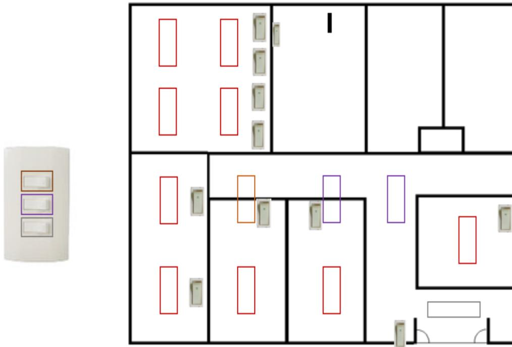
Ilustración 4.6 Cubículos y pasillos con luminaria LED y sus interruptores independientes.
