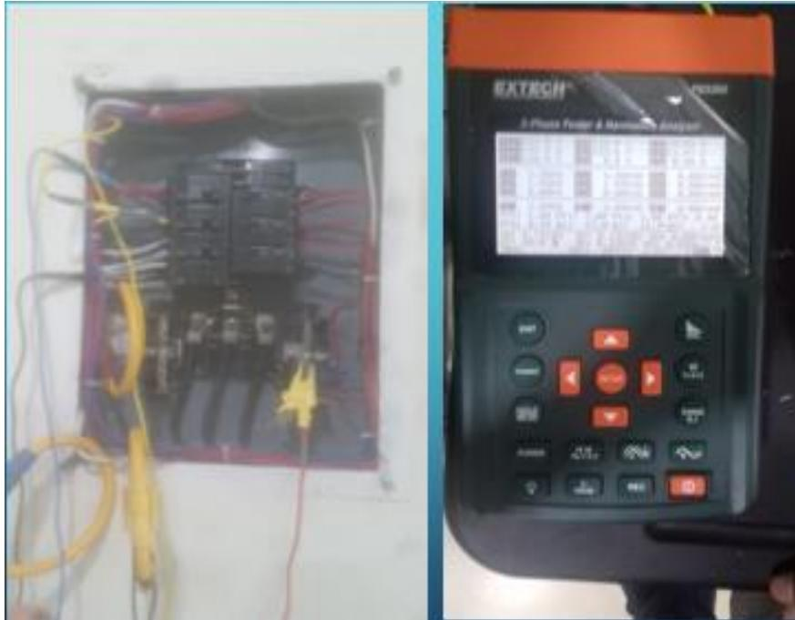
Ilustración 5.1 Conexión del inversor trifásico EXTECH para el análisis de aire acondicionado.
