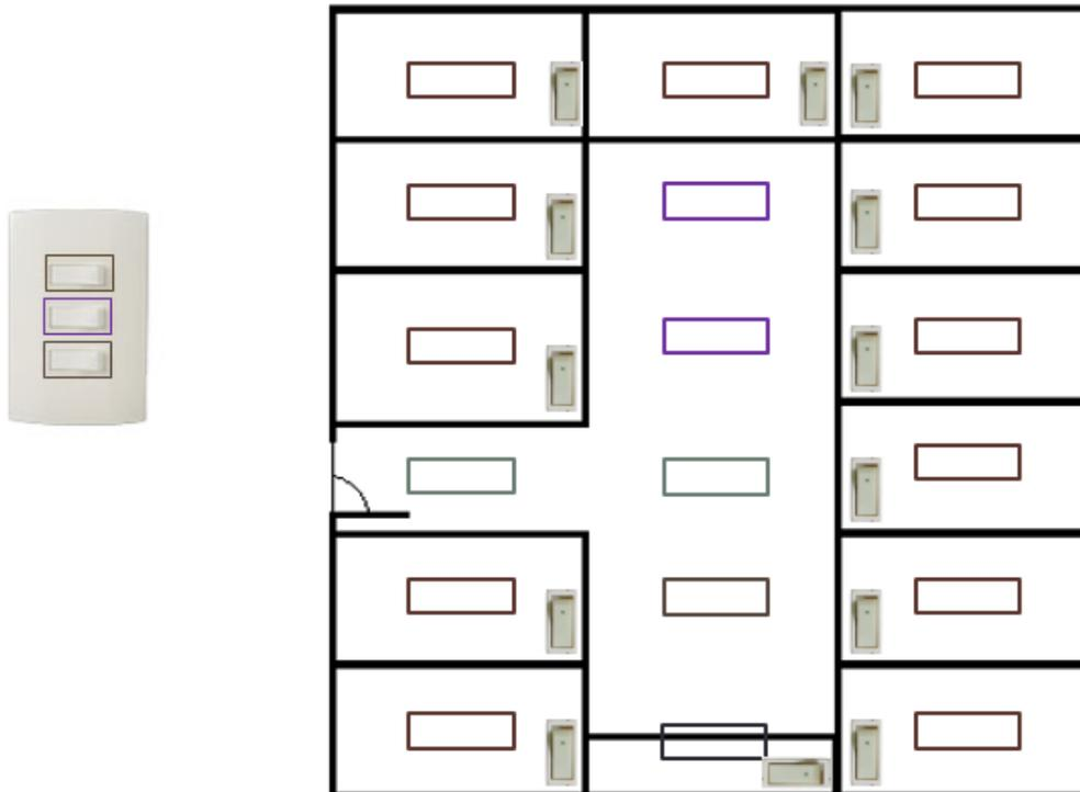
Ilustración 4.5 Cubículos y pasillos con luminaria LED y sus interruptores independientes.
