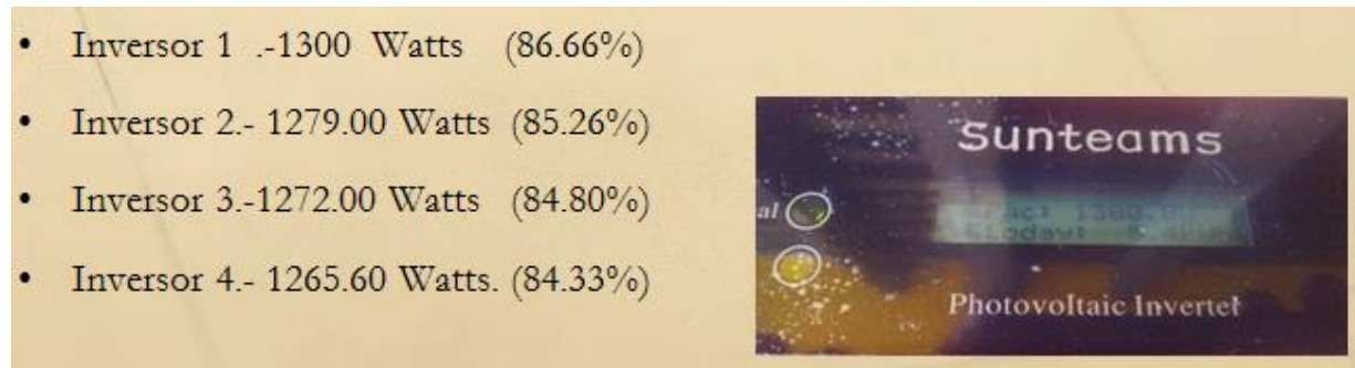
Figura 19 Lecturas de energía generada en el inversor
