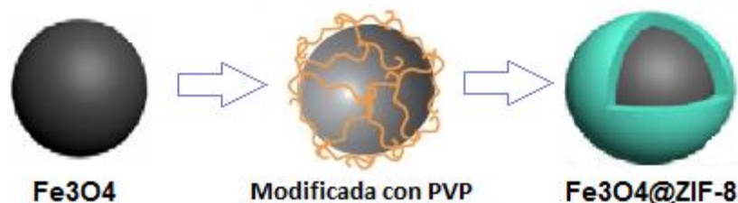
Figura 4 Esquema de encapsulamiento de nanoesferas \text{Fe}_3\text{O}_4 en cristal ZIF 8
