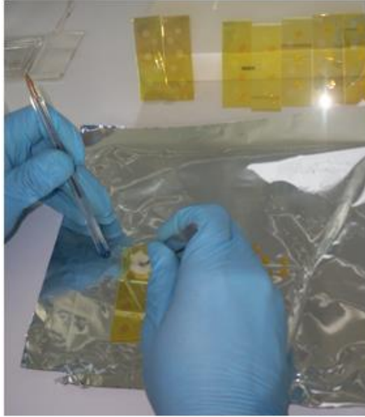
Figura 2.7. Retiro de la cinta kapton.
