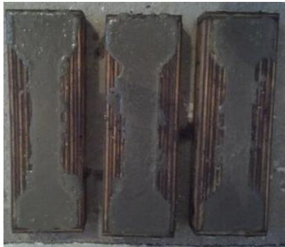
Figura 13. Probetas de mortero.
