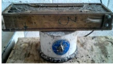
Figura 12. Vibrado del mortero.
