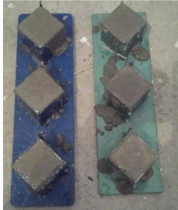
Figura 9. Especímenes y moldes de mortero para ensayos de compresión.
