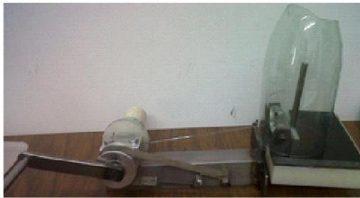
**Figura 10. Dispositivo mecánico-manual para cortar PET.**
