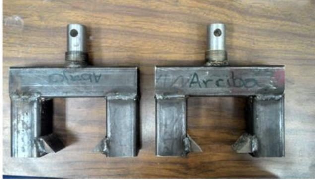
Figura 14. Mordazas para ensayos de tensión directa.
