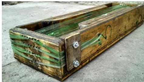
Figura 11. Sistema de sujeción de las tiras de PET.
