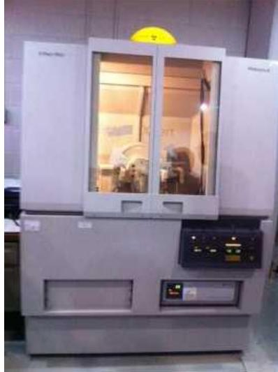
Figura 15. Difractómetro Panalytical X'Pert PRO.
