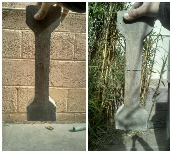
Figura 33. Probetas ensayadas que no presentan separación total.
