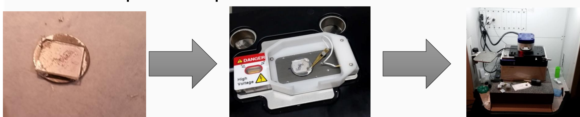
Figura 6. Preparación del sustrato para prueba PFM en AFM.
