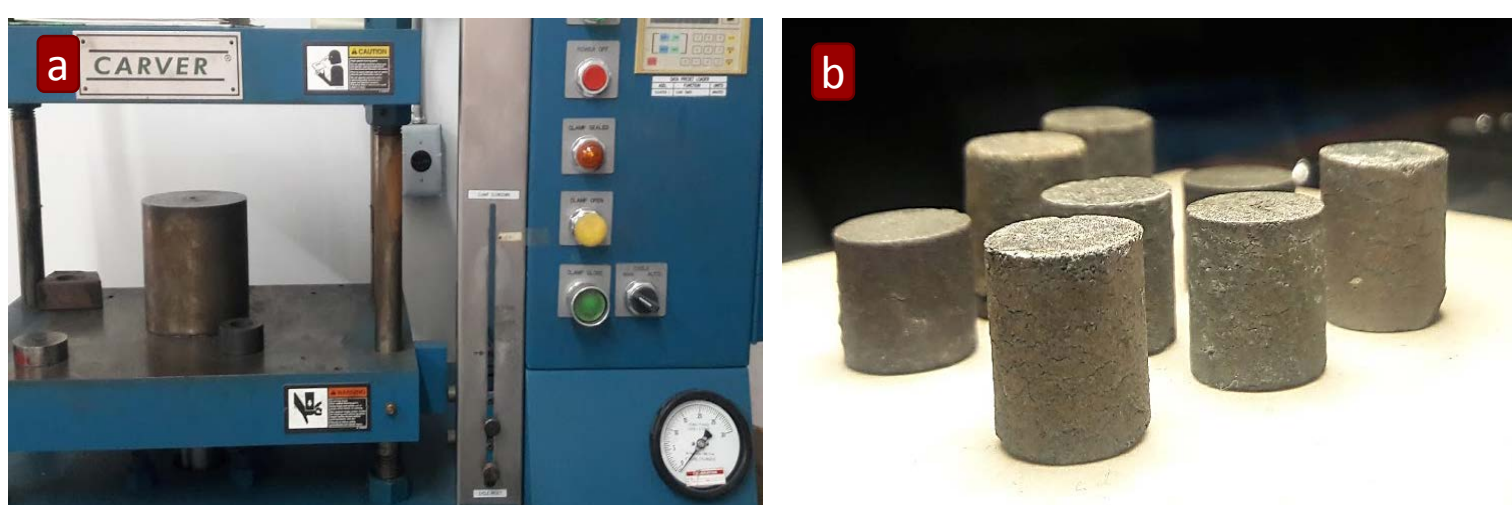
Figura 1. a) Prensa hidráulica b) Muestras después del prensado
