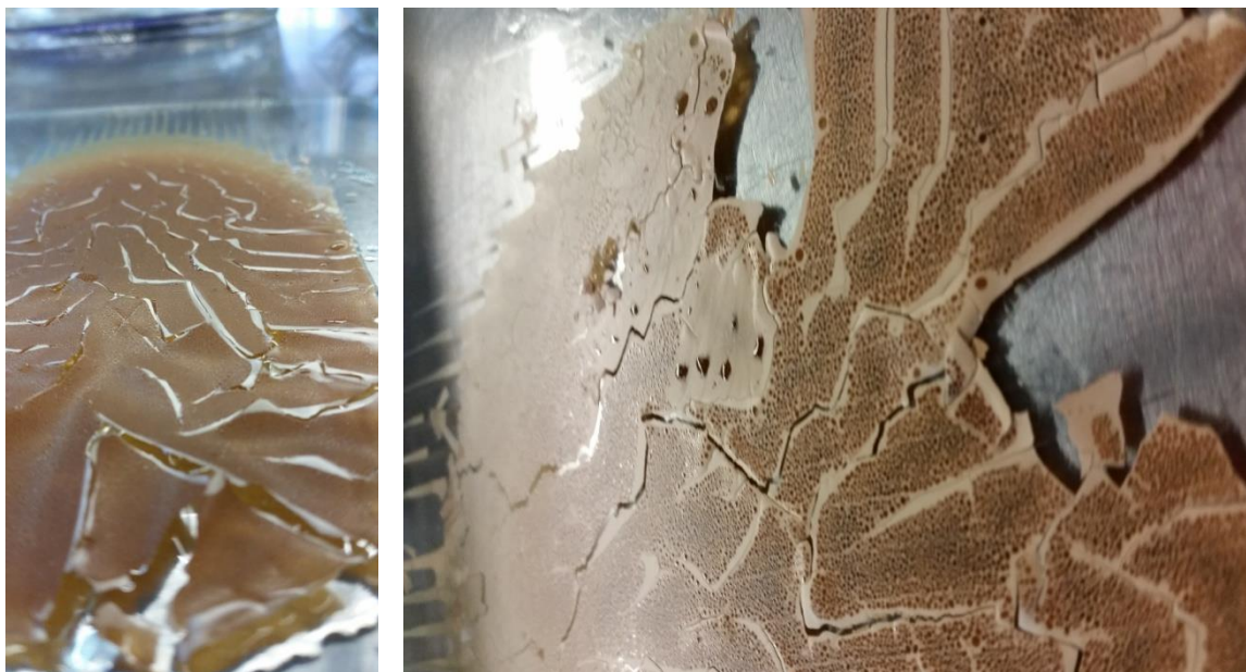
Figura. D.1. Pulpas acetiladas disueltas en dioxano al 14%, en contacto con agua después del casting sobre una placa de vidrio.
