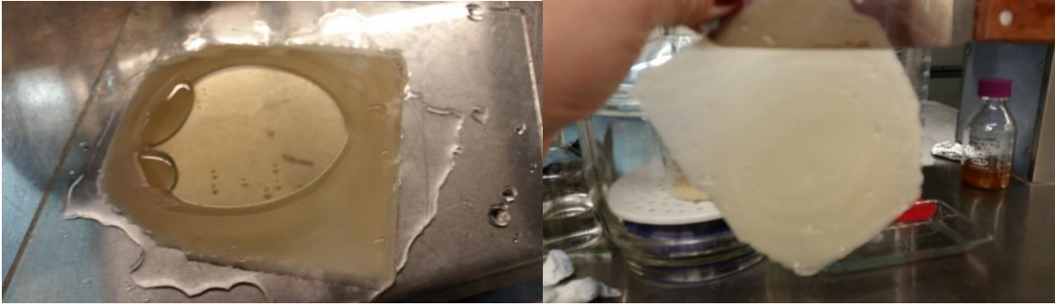
Figura. D.2. Pulpa proveniente del tratamiento etanosolv catalizado con ácido sulfúrico 0.05M a 180°C y 15 minutos, acetilada y disuelta en dioxano al 14%, en contacto con agua después del casting sobre una placa de vidrio.
