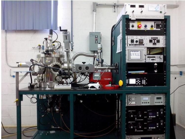
**Figura 15.** Sistema de pulverización catódica (sputtering) Marca AJA Modelo Orion-5.
