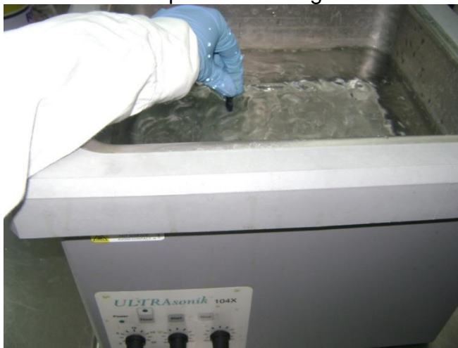
Figura 10. La muestra es colocada dentro de un vial cilíndrico con fondo cónico en ultrasonido durante 20 minutos para una mejor dispersión de los materiales.
