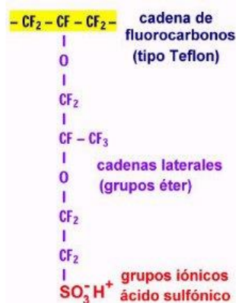
Figura 3. Estructura de la membrana Nafion® (membrana convencional de uso extendido).
