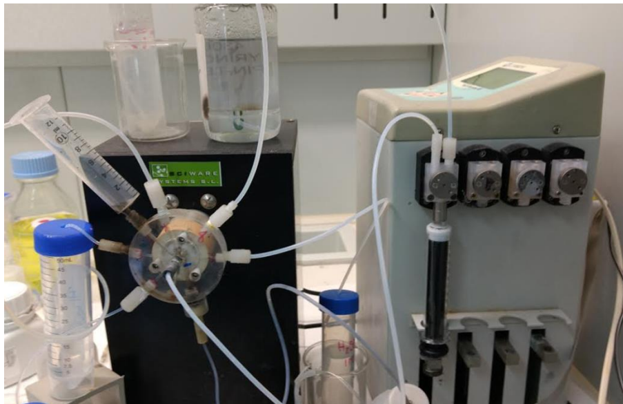
Figura 10.- Sistema LOV montado sobre una válvula de selección de ocho puertos laterales, y módulo multijeringa para la propulsión de los líquidos.
