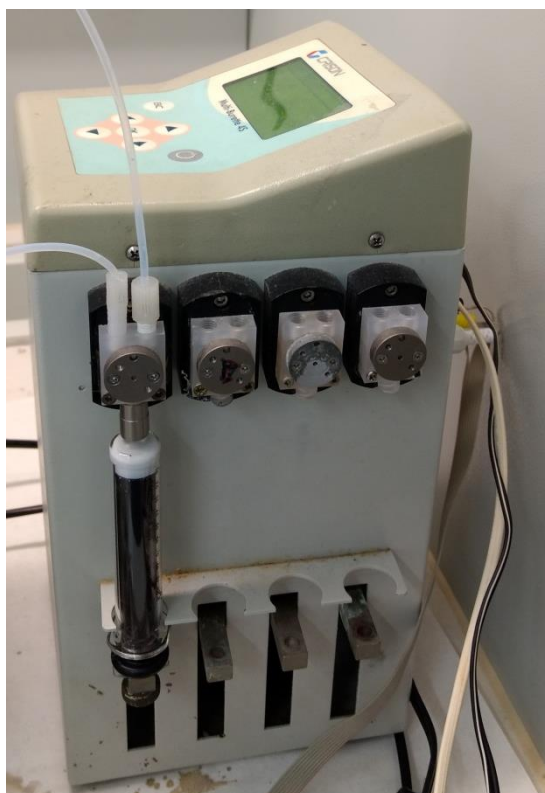
Figura 7.- Módulo multijeringa CRISON de 40 000 pasos, constituido por un motor paso a paso y una jeringa de 10 mL.
