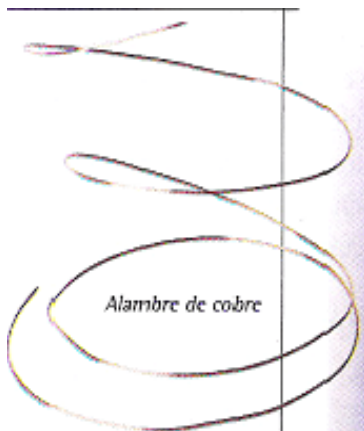
Fig. 3.15 Alambre de cobre se puede estirar hasta tener el grosor de la mitad de un cabello.
