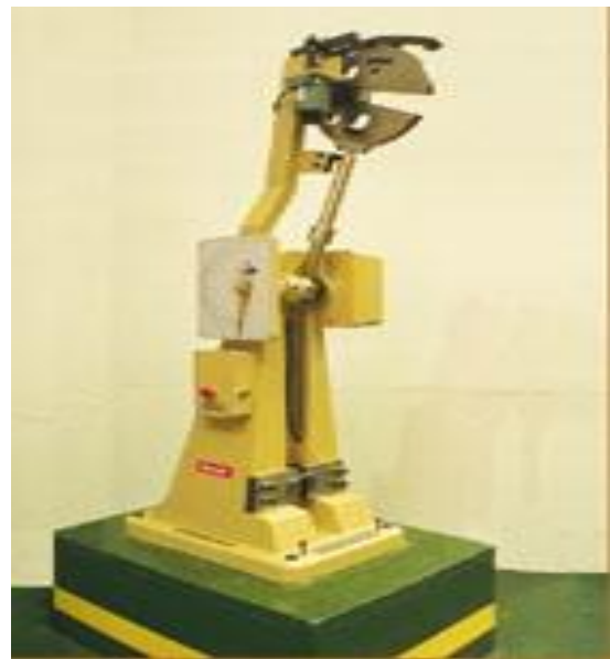
Figura 13: Péndulo industrial Charpy de la compañía Ibertest, España
